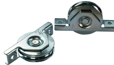
Galet Acier Galvanisé sur roulement à bille étanche diamètre 80mm livré monté sur le portail
