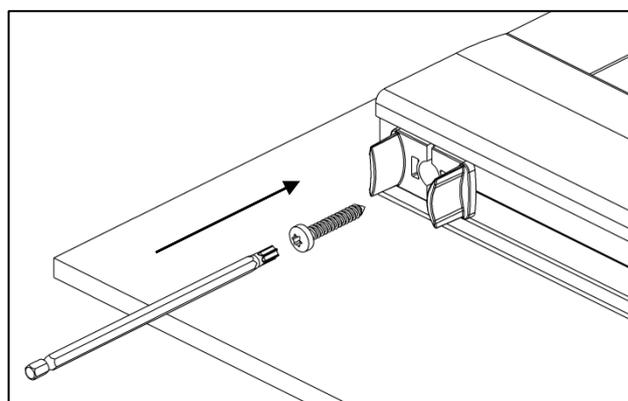
*Conseil pratique : Recouvrir l'extrémité de la vis, avant vissage, d'un peu de graisse. Le couple de vissage nécessaire sera moins important.*
