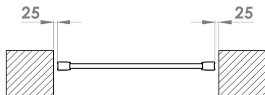
Le jeu de 25mm est prévu pour éviter les coincements de doigt entre le pilier et le montant du portail lors de l'ouverture du portail. Un montage avec un jeu inférieur à 25mm n'est pas recommandé et la responsabilité du fabricant ne pourra être engagée en cas d'accident.
