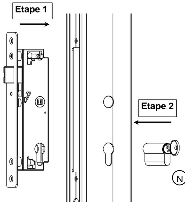
2 – Mettre en premier la vis repère **J** qui se positionne dans le cylindre puis les 2 autres vis repère **C** qui permettent de fixer la serrure sur le montant.
