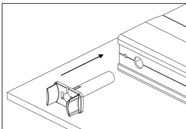
3 – Insérer le positionneur dans le 1<sup>er</sup> trou.
