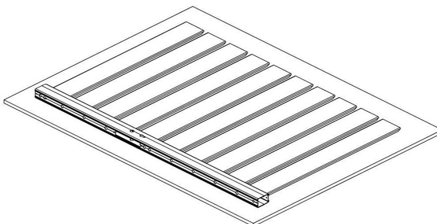
9 – Positionner le montant opposé sur les lames de remplissage (le mettre dans le même sens que le premier montant).
