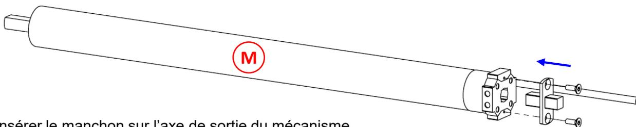
02 – Insérer le manchon sur l'axe de sortie du mécanisme.
